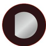
D-образное поперечное сечение для усовершенствования прокалывающей способности.
