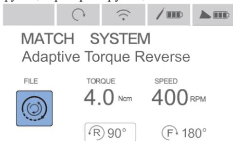
Обычное непрерывное вращение вперед, угол поворота вперед может быть изменен на 10°, угол устанавливается в диапазоне от 20° до 400°, а угол поворота назад по умолчанию равен 90°. Когда нагрузка на файл превысит установленный предел крутящего момента, файл начнет поочередно вращаться под установленным углом.
