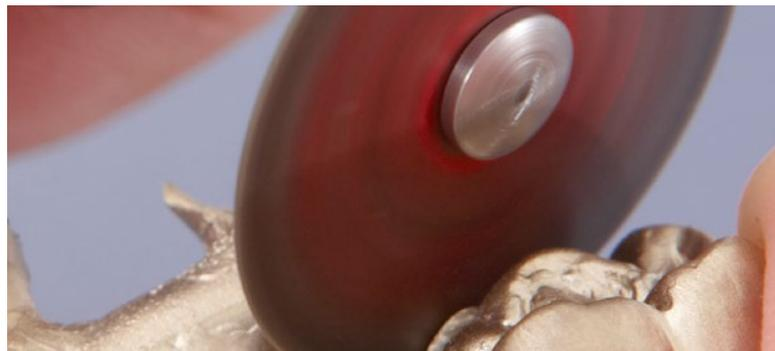
Эластичные и прочные, отрезные и шлифовальные диски с двойным армированием стекловолокном для сплавов благородных и неблагородных металлов и сплавов для модельного литья.
